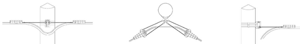
**ДЛЯ КАБЕЛЯ С ВЫНОСНЫМ СИЛОВЫМ ЭЛЕМЕНТОМ ИЗ ТРОСА, СТЕКЛОПЛАСТИКА ИЛИ ПРОВОЛОКИ, А ТАКЖЕ ДЛЯ КРУГЛОГО КОАКСИАЛЬНОГО КАБЕЛЯ**
